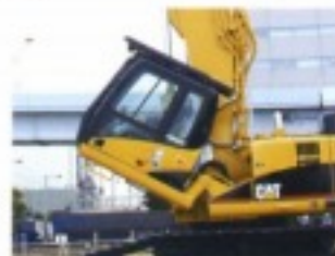
▶ キャブ全体の傾斜により、高所の作業箇所も楽に見上げられます。
