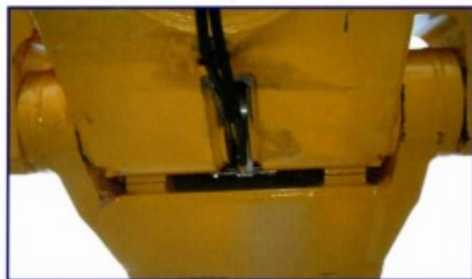
油圧シリンダによるピンの挿入・取外し
